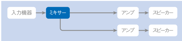
＜デジタルミキサーを使用した音響システム例＞
