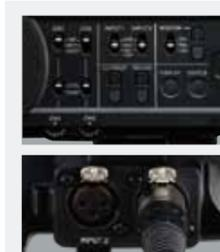
撮影時の環境音収録に便利なステレオマイク内蔵。さらにXLRオーディオ端子2系統を装備し、MIC/LINE切替による音声入力可能。マニュアル時、チャンネル別レベル調整ができ、ファントム電源(+48V)出力にも対応。また、ワイヤレスレーザー接続可能なAUX入力端子も装備。
