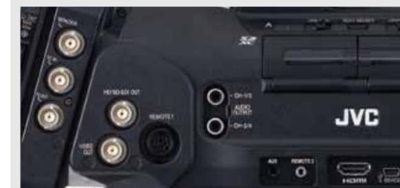
GENLOCK入力、TC入出力、SDI (HD/SD) 出力、VIDEO出力、MIC/LINE入力×2、AUX入力(Φ3.5mm、ステレオミニ)、リモート×2 (JVC専用/LANC)、オーディオ出力×2 (RCA)、HDMI出力、USB2.0 (ミニB)
