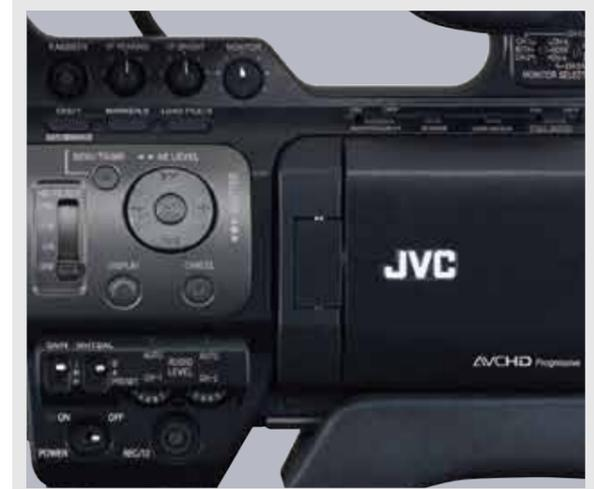
ファンクションメニュー ホワイトバランス、ゲイン(L/M/H)、フルオート(ON/OFF)、NDフィルター(OFF、1/4、1/16、1/64)、オート/マニュアルフォーカス、ワンタッチオートシャッター、フォーカスアシスト(ON/OFF)、手振れ補正(ON/OFF)、LoLux(ON/OFF)、マーカー(ON/OFF)、ゼブラ(ON/OFF)、AEロック(ON/OFF)
