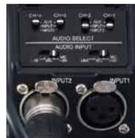
高性能な指向性マイクを標準装備。MIC/LINE切替可能なXLRオーディオ入力端子×2系統により、マニュアル時のチャンネル別レベル調整やファントム電源出力(+48V)にも対応。さらに、ワイヤレスレシーバーなどの接続も可能なAUX入力端子(2ch)も装備。
