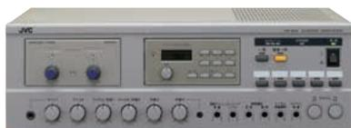
800MHzワイヤレスチューナーユニット、ラジオチューナーユニット組込み例
