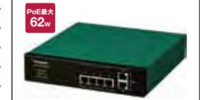
PoE給電能力:最大62W ポート構成:10/100/1000Mbps×6ポート(PoE対応4ポート) 消費電力:最小3.7W/最大75.0W 動作温度:0~50℃ 外形寸法・質量:幅210×高さ44×奥行210mm、1.7kg ※ゴム足付属
