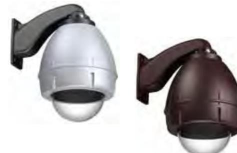
使用環境:屋外一般 使用温度:-50℃~+45℃ 防塵防水等級:IP54(通気口開状態)、IP66(通気口閉状態) 材質:ABS UL94 V-0(本体/PC)、UL94 V-0(カバー/PC)、アルミ合金(金具、金具接合部)、SUS304(ビス部) 仕上げ:シルバー色、金具部ブラック/ブラウン色、金具部ダークブラウン(マンセル5YR2/1.5近似) 消費電力:25W(カメラ含まず) 外形寸法・質量:幅284×高さ450×奥行き388mm(ドーム部)、4.6kg 装備:ファン、ヒーター
