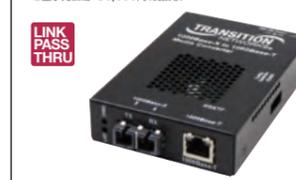
SGETF1013-110:1000BASE-T(RJ-45)[100m]⇔1000BASE-SX 850nmマルチモード(SC)[62.5/125μmファイバ:220m]、リンクバジェット:7.0dB[50/125μmファイバ:550m] SGETF1014-110:1000BASE-T(RJ-45)[100m]⇔1000BASE-LX1310nmシングルモード(SC)[ファイバ:10km]、リンクバジェット:10.5dB 電源:ACアダプタ:12VDC(付属) 外形寸法・質量:幅82×高さ25×奥行122mm、0.9kg
