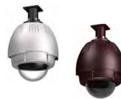
使用環境:屋外一般 使用温度:-50℃~+45℃ 防塵防水等級:IP54(通気口開状態)、IP66(通気口閉状態) 材質:ABS UL94 V-0(本体/PC)、UL94 V-0(カバー/PC)、アルミ合金(金具、金具接合部)、SUS304(ビス部) 仕上げ:シルバー色、金具部ブラック/ブラウン色、金具部ダークブラウン(マンセル5YR2/1.5近似) 消費電力:25W(カメラ含まず) 外形寸法・質量:φ308×高さ469.5mm(ドーム部)、5.3kg 装備:ファン、ヒーター
