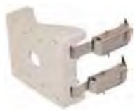
径調整可能サイズ: φ150~φ300mm 主な材質: アルミ/ステンレスベルト 外形寸法: 幅200×高さ132×奥行き47mm 質量・最大積載質量: 0.9kg, 15kg 仕上げ: 半艶シボアイボリーレーザー焼付け塗装 付属品: M8ボルト、スプリング・平座金各4, およびステンレスベルト2本 ※耐塩塗装については別途ご相談ください
