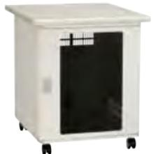
材質: 鉄 ハンドル: ラッチハンドル(キーNo.N200) 規格: EIA規格 塗装色: ベールホワイト(10YR8.5/0.5)日塗工J19-85A 許容荷重: 100kg(キャスターの取付位置により50kg) 外形寸法・質量: 幅598×高さ699×奥行き698mm, 23kg
