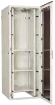
材質: 鉄 ハンドル: ハンドル(キーNo.N200) 規格: EIA規格 塗装色: ベールホワイト(10YR8.5/0.5)日塗工J19-85A 許容荷重: 600kg 耐震荷重: 300kg/兵庫県南部地震波(818gal)※代表機種(F590-720EN)の日東工業(株)搭載条件による試験結果です 外形寸法・質量: 幅600×高さ2000×奥行き900mm, 118kg 標準装備品: スリット付台板セット(RD152-60SN)×3セット、換気扇・低騒音タイプ×4コ(プラグコード付)、コンセントバー(RD81-10N)×1コ、ケーブルホルダー(RD87-15K)×1セット(10コ入)
