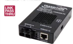
E-100BTX-FX-05(SC):100BASE-TX(RJ-45)[100m]⇔100BASE-FX 1300nmマルチモード(SC)[2km]、リンクバジェット:11.0dB E-100BTX-FX-05(SM):100BASE-TX(RJ-45)[100m]⇔100BASE-FX 1310nmシングルモード(SC)[20km]、リンクバジェット16.0dB 電源:ACアダプタ:12VDC(付属) 外形寸法・質量:幅82×高さ25×奥行122mm、0.9kg
