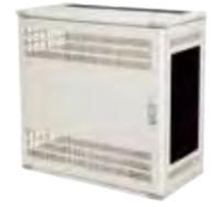
材質: 鉄 ハンドル: 平面ハンドル(キーNo.N200) 塗装色: ベールホワイト(10YR8.5/0.5)日塗工J19-85A 取付部: 19インチマウントユニット(2.3mm)、木製基板(12mm) キャビネット板厚ボデー0.8/1.6mm, 右ドア0.8mm, 左側板0.8mm, 開口プレート1.0mm, 天板/底板0.8mm 扉形式: 前面及び右側面ドア式
