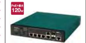
PoE給電能力:最大120W ポート構成:10/100/1000T×6ポート(PoE対応4ポート)、SFP×2ポート 消費電力:最小13W/最大168W 外形寸法・質量:幅210×高さ44×奥行260mm、2.2kg ※マグネット付属※19インチラックマウント金具、壁取付用金具別売※10/100/1000TとSFPの1ポートは排他利用※1ポートあたり30Wまで供給可能
