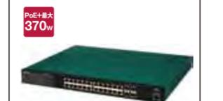
PoE給電能力:最大370W ポート構成:10/100/1000T×24ポート(PoE対応24ポート)、SFP×4ポート 消費電力:最小35.9W/最大503W 外形寸法・質量:幅440×高さ44×奥行386mm、5.5kg ※19インチラックマウント金具付属※10/100/1000TとSFPポートは排他利用
