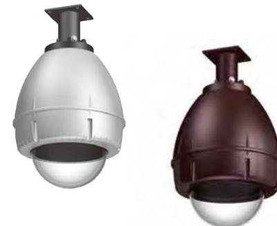
使用環境:屋外一般 使用温度:-50℃~+45℃ 防塵防水等級:IP54(通気口開状態)、IP66(通気口閉状態) 材質:ABS UL94 V-0(本体/PC)、UL94 V-0(カバー/PC)、アルミ合金(金具、金具接合部)、SUS304(ビス部) 仕上げ:シルバー色、金具部ブラック/ブラウン色、金具部ダークブラウン(マンセル5YR2/1.5近似) 消費電力:25W(カメラ含まず) 外形寸法・質量:φ284×高さ468mm(ドーム部)、4.4kg 装備:ファン、ヒーター
