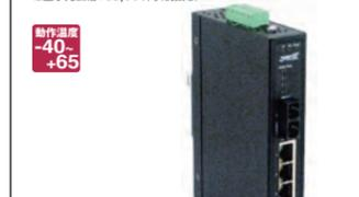
SISTP1013-141-LRT:10/100BASE-TX(RJ-45)[100m]⇔100BASE-FX1300nmマルチモード(SC)[2km]、リンクバジェット11.0dB SISTP1014-141-LRT:100BASE-TX(RJ-45)[100m]⇔100BASE-FX1310nmシングルモード(SC)[20km]、リンクバジェット:17.0dB 電源:DC48V(電源ユニット別途)、冗長電源入力 IP等級保護:IP30 給電能力:各ポート最大15.4W(IEEE802.3af) 環境規格:拡張動作温度-40~+65℃、動作湿度5~95%(結露無し)、動作高度0~3000m 外形寸法・質量:幅30×高さ140×奥行き95mm、0.64kg
