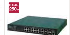
PoE給電能力:最大250W ポート構成:10/100/1000T×18ポート(PoE対応16ポート)、SFP×2ポート 消費電力:最小19.5W/最大351W 外形寸法・質量:幅330×高さ44×奥行330mm、3.7kg ※19インチラックマウント金具付属 ※10/100/1000TとSFPポートは排他利用
