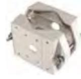
径調整可能サイズ:φ65~φ125mm 主な材質:アルミ/ステンレスボルト 外形寸法:幅200×高さ132×奥行き47mm 質量・最大積載質量:1.5kg、15kg 仕上げ:半艶シボ アイボリーレザートーン焼付け塗装 付属品:M10ボルト×2、ナット・スプリング・平座金各4、M8ボルト、スプリング・平座金各4 ※耐塩塗装については別途ご相談ください
