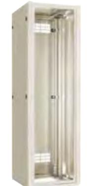
材質: 鉄 規格: EIA規格 塗装色: ベールホワイト(10YR8.5/0.5)日塗工J19-85A 許容荷重: 600kg 耐震荷重: 300kg/兵庫県南部地震波(818gal)※代表機種(F5N80-620E)の日東工業(株)搭載条件による試験結果です 外形寸法・質量: 幅600×高さ2000×奥行き600mm, 75kg
