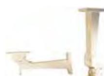
最大角度調整(壁・天井とも):上30°下90° 回転±120° 主な材質:アルミ 外形寸法:(壁付)幅71×高さ160×奥行き374mm、(天井):幅71×高さ373×奥行き155mm 質量・最大積載質量:950g、15kg
