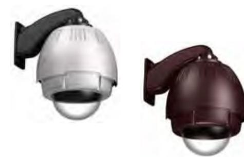
使用環境:屋外一般 使用温度:-50℃~+45℃ 防塵防水等級:IP54(通気口開状態)、IP66(通気口閉状態) 材質:ABS UL94 V-0(本体/PC)、UL94 V-0(カバー/PC)、アルミ合金(金具、金具接合部)、SUS304(ビス部) 仕上げ:シルバー色、金具部ブラック/ブラウン色、金具部ダークブラウン(マンセル5YR2/1.5近似) 消費電力:25W(カメラ含まず) 外形寸法・質量:幅308×高さ451.5×奥行き400mm(ドーム部)、5.5kg 装備:ファン、ヒーター
