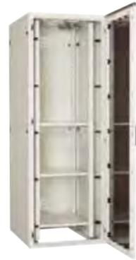
材質: 鉄 ハンドル: ハンドル(キーNo.N200) 規格: EIA規格 塗装色: ベールホワイト(10YR8.5/0.5)日塗工J19-85A 許容荷重: 600kg 耐震荷重: 300kg/兵庫県南部地震波(818gal)※代表機種(F590-720EN)の日東工業(株)搭載条件による試験結果です 外形寸法・質量: 幅600×高さ2000×奥行き600mm, 98kg 標準装備品: スリット付台板セット(RD152-30SN)×3セット、換気扇・低騒音タイプ×4コ(プラグコード付)、コンセントバー(RD81-10N)×1コ、ケーブルホルダー(RD87-15K)×1セット(10コ入)
