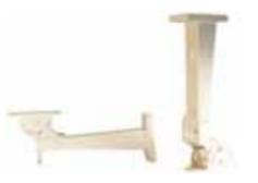
最大角度調整(壁付・天井とも): 上30°下90° 回転±120° 主な材質: アルミ 外形寸法: (壁付)幅71×高さ160×奥行き374mm、(天井):幅71×高さ373×奥行き155mm 質量・最大積載質量: 950g、15kg 仕上げ: 半艶アイボリー焼付け塗装 付属品: M6ボルト、スプリング・平座金各3
