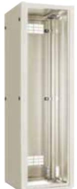
材質:鉄 規格:EIA規格 塗装色:パールホワイト(10YR8.5/0.5)日塗工J19-85A 許容荷重:600kg 耐震荷重:300kg/兵庫県南部地震波(818gal)\*代表機種(FSN80-620E)の日東工業(株)搭載条件による試験結果です 外形寸法・質量:幅600×高さ2000×奥行き600mm、75kg
