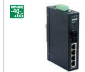
SISTP1013-141-LRT:10/100BASE-TX(RJ-45)[100m]≧100BASE-FX1300nmマルチモード(SC)[2km]、リンクバジェット11.0dB SISTP1014-141-LRT:100BASE-TX(RJ-45)[100m]≧100BASE-FX1310nmシングルモード(SC)[20km]、リンクバジェット:17.0dB 電源:DC48V(電源ユニット別途)、冗長電源入力 IP等級保護:IP30 給電能力:各ポート最大15.4W(IEEE802.3af) 環境規格:拡張動作温度-40~+65℃、動作湿度5~95%(結露無し)、動作高度0~3000m 外形寸法・質量:幅30×高さ140×奥行き95mm、0.64kg
