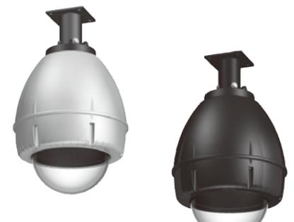
使用環境: 屋外一般 使用温度: -50℃~+45℃ 防塵防水等級: IP54(通気口開状態)、IP66(通気口閉状態) 材質: ABS UL94 V-0(本体/PC)、UL94 V-0(カバー/PC)、アルミ合金(金具、金具接合部)、SUS304(ビス部) 仕上げ: シルバー色、金具部ブラック/ブラウン色、金具部ダークブラウン(マンセル5YR2/1.5近似) 消費電力: 25W(カメラ含まず) 外形寸法・質量: φ284×高さ468mm(ドーム部)、4.4kg 装備: ファン、ヒーター
