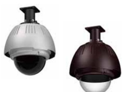
使用環境: 屋外一般 使用温度: -50℃~+45℃ 防塵防水等級: IP54(通気口開状態)、IP66(通気口閉状態) 材質: ABS UL94 V-0(本体/PC)、UL94 V-0(カバー/PC)、アルミ合金(金具、金具接合部)、SUS304(ビス部) 仕上げ: シルバー色、金具部ブラック/ブラウン色、金具部ダークブラウン(マンセル5YR2/1.5近似) 消費電力: 25W(カメラ含まず) 外形寸法・質量: φ308×高さ469.5mm(ドーム部)、5.3kg 装備: ファン、ヒーター
