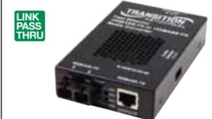
E-100BTX-FX-05(SC):100BASE-TX(RJ-45)[100m]≧100BASE-FX 1300nmマルチモード(SC)[2km]、リンクバジェット:11.0dB E-100BTX-FX-05(SM):100BASE-TX(RJ-45)[100m]≧100BASE-FX 1310nmシングルモード(SC)[20km]、リンクバジェット16.0dB 電源:ACアダプタ:12VDC(付属) 外形寸法・質量:幅82×高さ25×奥行122mm、0.9kg
