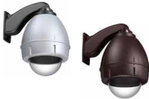
使用環境: 屋外一般 使用温度: -50℃~+45℃ 防塵防水等級: IP54(通気口開状態)、IP66(通気口閉状態) 材質: ABS UL94 V-0(本体/PC)、UL94 V-0(カバー/PC)、アルミ合金(金具、金具接合部)、SUS304(ビス部) 仕上げ: シルバー色、金具部ブラック/ブラウン色、金具部ダークブラウン(マンセル5YR2/1.5近似) 消費電力: 25W(カメラ含まず) 外形寸法・質量: 幅284×高さ450×奥行き388mm(ドーム部)、4.6kg 装備: ファン、ヒーター
