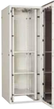
材質:鉄 ハンドル:キー付ハンドル(キーNo.N200) 規格:EIA規格 塗装色:パールホワイト(10YR8.5/0.5)日塗工J19-85A 許容荷重:600kg 耐震荷重:300kg/兵庫県南部地震波(818gal)\*代表機種(F590-720EN)の日東工業(株)搭載条件による試験結果です 外形寸法・質量:幅600×高さ2000×奥行き900mm、118kg 標準装備品:スリット付台板セット(RD152-60SN)×3セット、換気扇・低騒音タイプ×4コ(プラグコード付)、コンセントバー(RD81-10N)×1コ、ケーブルホルダー(RD87-15K)×1セット(10コ入)
