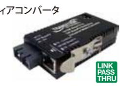
M/E-ISW-FX-01(SC):100BASE-TX(RJ-45)[100m]≧100BASE-FX 1300nmマルチモード(SC)[2km]、リンクバジェット12.0dB M/E-ISW-FX-01(SM):100BASE-TX(RJ-45)[100m]≧100BASE-FX 1310nmシングルモード(SC)[20km]、リンクバジェット16.0dB 動作温度:-40~75℃ 電源:別売(DC12V) 外形寸法・質量:幅46×高さ22×奥行85mm、0.9kg
