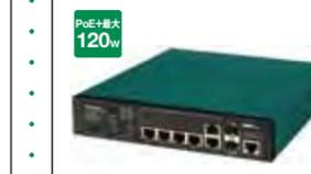
PoE給電能力:最大120W ポート構成:10/100/1000T×6ポート(PoE対応4ポート)、SFP×2ポート 消費電力:最小13W/最大168W 外形寸法・質量:幅210×高さ44×奥行260mm、2.2kg ※マグネット付属※19インチラックマウント金具、壁取付用金具別売※10/100/1000TとSFPの1ポートは排他利用※1ポートあたり30Wまで供給可能
