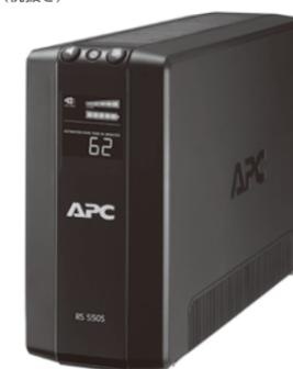
バッテリータイプ: 小型シール鉛蓄電池 (長寿命タイプ) 運転方式: ラインインタラクティブ 入力電圧範囲: 初期設定 下限82V~上限123V (同梱ソフトウェアで変更可能) 入力コンセント形状: NEMA5-15P (入力プラグ変換アダプタ付き) 出力コンセント数: 電源バックアップ+サージ保護×3、サージ保護のみ×3 最大出力容量: 550VA/330W 外形寸法・質量: 幅91×高さ190×奥行き310mm、7.0kg 付属品: ユーザーズマニュアル、ソフトウェアCD、USB通信ケーブル、入力プラグ変換アダプター 保証期間: 3年
