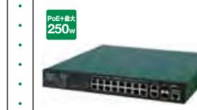
PoE給電能力:最大250W ポート構成:10/100/1000T×18ポート(PoE対応16ポート)、SFP×2ポート 消費電力:最小19.5W/最大351W 外形寸法・質量:幅330×高さ44×奥行330mm、3.7kg ※19インチラックマウント金具付属 ※10/100/1000TとSFPポートは排他利用
