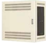
材質:鉄 ハンドル:キー付ハンドル(キーNo.N200) 塗装色:クリーム(2.5Y9/1)日塗工J22-90B 取付基板:19型マウントユニット(2.3mm)、木製基板(12mm) キャビネット板厚ボデー1.2mm、ドア1.2mm、右側面ドア1.0mm、開口プレート1.2mm 扉形式:前面及び右側面ドア式
