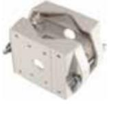
径調整可能サイズ: φ65~φ125mm 主な材質: アルミ/ステンレスボルト 外形寸法: 幅200×高さ132×奥行き47mm 質量・最大積載質量: 1.5kg、15kg 仕上げ: 半艶シボ アイボリーレザートーン焼付け塗装 付属品: M10ボルト×2、ナット・スプリング・平座金各4、M8ボルト、スプリング・平座金各4
