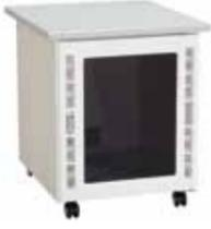
材質:鉄 ハンドル:キー付ハンドル(キーNo.N200) 規格:EIA規格 塗装色:パールホワイト(10YR8.5/0.5)日塗工J19-85A 許容荷重:100kg(キャスターの取付位置により50kg) 外形寸法・質量:幅600×高さ699×奥行き700mm、21kg
