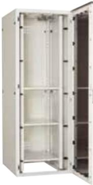
材質:鉄 ハンドル:キー付ハンドル(キーNo.N200) 規格:EIA規格 塗装色:パールホワイト(10YR8.5/0.5)日塗工J19-85A 許容荷重:600kg 耐震荷重:300kg/兵庫県南部地震波(818gal)\*代表機種(F590-720EN)の日東工業(株)搭載条件による試験結果です 外形寸法・質量:幅600×高さ2000×奥行き600mm、98kg 標準装備品:スリット付台板セット(RD152-30SN)×3セット、換気扇・低騒音タイプ×4コ(プラグコード付)、コンセントバー(RD81-10N)×1コ、ケーブルホルダー(RD87-15K)×1セット(10コ入)
