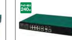
PoE給電能力:最大240W ポート構成:10/100/1000T×10ポート(PoE対応8ポート)、SFP×2ポート 消費電力:最小18W/最大319W 外形寸法・質量:幅250×高さ44×奥行330mm、3.0kg ※19インチラックマウント金具、壁取付用金具別売※10/100/1000TとSFPポートは排他利用
