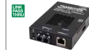
SGETF1013-110:1000BASE-T(RJ-45)[100m]≧1000BASE-SX 850nmマルチモード(SC)[62.5/125μmファイバ:220m]、リンクバジェット:7.0dB[50/125μmファイバ:550m] SGETF1014-110:1000BASE-T(RJ-45)[100m]≧1000BASE-LX 1310nmシングルモード(SC)[ファイバ:10km]、リンクバジェット:10.5dB 電源:ACアダプタ:12VDC(付属) 外形寸法・質量:幅82×高さ25×奥行122mm、0.9kg
