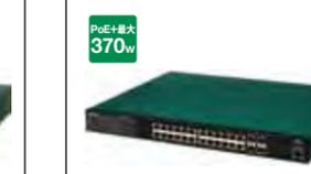
PoE給電能力:最大370W ポート構成:10/100/1000T×24ポート(PoE対応24ポート)、SFP×4ポート 消費電力:最小35.9W/最大503W 外形寸法・質量:幅440×高さ44×奥行386mm、5.5kg ※19インチラックマウント金具付属※10/100/1000TとSFPポートは排他利用
