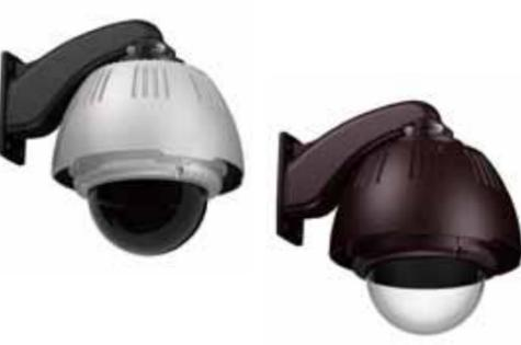
使用環境: 屋外一般 使用温度: -50℃~+45℃ 防塵防水等級: IP54(通気口開状態)、IP66(通気口閉状態) 材質: ABS UL94 V-0(本体/PC)、UL94 V-0(カバー/PC)、アルミ合金(金具、金具接合部)、SUS304(ビス部) 仕上げ: シルバー色、金具部ブラック/ブラウン色、金具部ダークブラウン(マンセル5YR2/1.5近似) 消費電力: 25W(カメラ含まず) 外形寸法・質量: 幅308×高さ451.5×奥行き400mm(ドーム部)、5.5kg 装備: ファン、ヒーター
