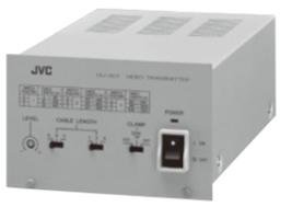
映像入力:1回路、VBS1.0V(p-p)、75Ω、BNC 映像出力:2回路、VBS1.0V(p-p)、75Ω、BNCケーブル補償:9ポジション切換式(5C-2V同軸ケーブル40m、160m、320m、440m、560m、720m、840m、960m、1120m、相当分を補償) 電源:AC100V、50Hz/60Hz 消費電力:3.4W 外形寸法・質量:幅140×高さ93×奥行239mm、1.7kg 仕上:マンセル3Y6/0.6近似(ライトグレー) 適合ラックマウント金具:UC-P1012(EIA 2U/別売)
