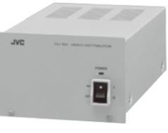
分配数:1入力6分配、または2入力3分配 映像入力:2回路、VBS1.0V(p-p)、75Ω、BNC(スルーアウトプット、75Ω終端スイッチ付) 映像出力:3回路×2、VBS1.0V(p-p)、75Ω、BNCケーブル補償:2ポジション切換式(「切」/補償なし、「入」/5C-2V 150mを補償) 電源:AC100V、50Hz/60Hz 消費電力:4.9W 周囲温度:-10℃~+50℃(動作)、0℃~+40℃(推奨) 外形寸法・質量:幅140×高さ93×奥行239mm、1.6kg 仕上:マンセル3Y6/0.6近似(ライトグレー) 適合ラックマウント金具:UC-P1012(EIA 2U/別売)
