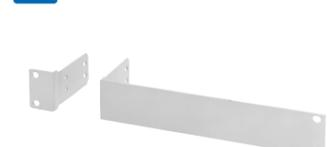
適合機種:TK-U1006、VN-E4B マウントサイズ:EIA1U 質量:320g 材質:SPCC鋼板t=1.6 仕上:ライトグレー塗装(マンセル3Y6/0.6近似、日塗工HN-65(2015年)近似) 付属品:M4タッピングねじ×4、ラックマウント用M5タッピングねじ×4
