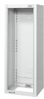
ユニット取付寸法:1379mm(EIA 31ユニット) ユニット取付最小間隔:44mm 寸法・質量:幅570×高さ1503×奥行454mm、約40kg 仕上:アイボリー半艶焼付塗装(マンセル25Y9/1近似)
