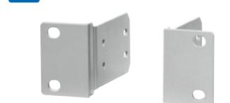
適合機種:TK-U1006×2台、VN-E4B×2台 マウントサイズ:EIA1U 質量:120g 材質:SPCC鋼板t=1.6 仕上:ライトグレー塗装(マンセル3Y6/0.6近似、日塗工HN-65(2015年)近似) 付属品:M4タッピングねじ×4、ラックマウント用M5タッピングねじ×4
