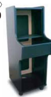
ユニット取付寸法:上部10U(奥行415mm)、下部14U(奥行531.5mm)、水平操作部6U(奥行185mm) ユニット取付最小間隔:44.5mm 使用キャスター:φ75mm×4(操作面側の2個はストッパー付) 寸法・質量:幅547×高さ1510×奥行745mm、45.7kg 仕上(主要部):ウレタンエナメル塗装(黒色)
