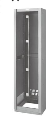
ユニット取付寸法:1826mm(EIA 41ユニット) ユニット取付最小間隔:44mm 寸法・質量:幅570×高さ2000×奥行572mm、60kg 仕上:ディープグレー半艶レーザー焼付塗装(マンセル1Y2/0.2近似)
