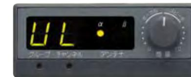
ワイヤレスマイクの電波をどれくらいの強さで受信しているか確認できるスイッチです。「入」にするとチューナーのグループ/チャンネル表示部に、電波の強さを5段階表示します。移動型アンテナ使用時など、サービスエリアの確認に便利です。
