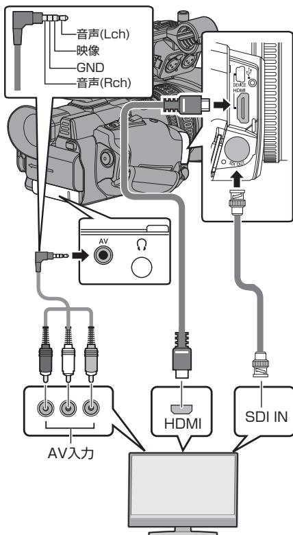
※ [映像/音声設定] → [HDMI/SDI 出力] 項目で出力信号を選択します。
