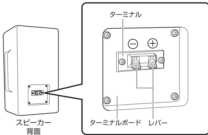
レバーを押し下げたまま、ターミナルの④端子と①端子にスピーカーコードを接続する。
