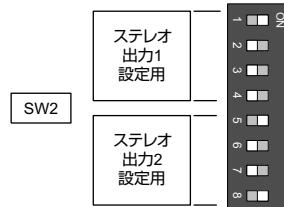
■ ステレオ出力 1 のスピーカーパラメーターを PS-S508L / PS-S508R に設定する
