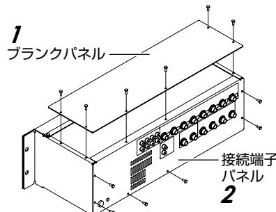
3 内部のケーブルに注意しながら接続端子パネルを本体上面に取り付けます
