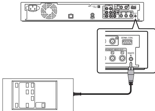
有線で接続することにより、安定した外部操作ができます。本体のリモコンコード設定が1~4のどのコードに設定されていても、ワイヤードリモコンで操作できます。
