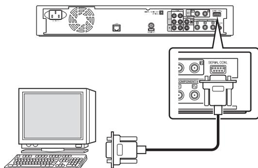
RS-232C ケーブルで PC などと接続することにより、外部操作ができます。外部操作について詳しくは、「外部制御」(P.88ページ)を参照してください。
