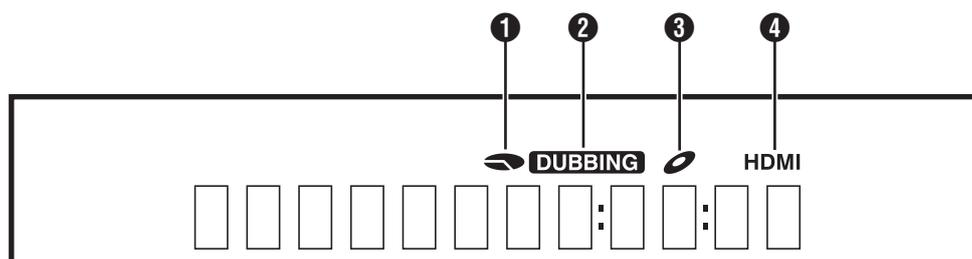
① HDD/DISC 残量表示
