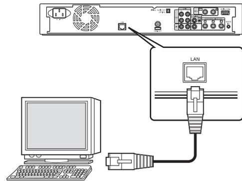
LAN ケーブルで PC などと接続することにより、外部操作ができます。外部操作について詳しくは、「外部制御」(P.88ページ)を参照してください。
