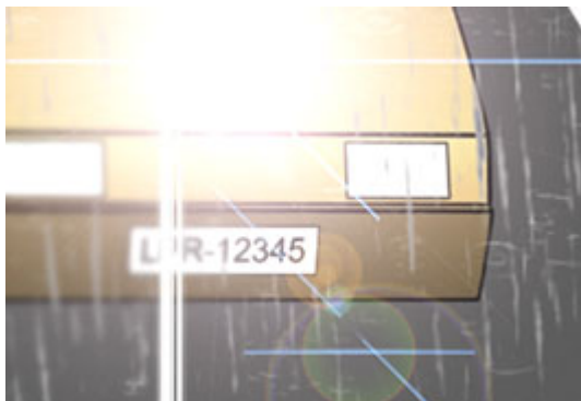
露出過度でシミができたナンバープレートの画像
