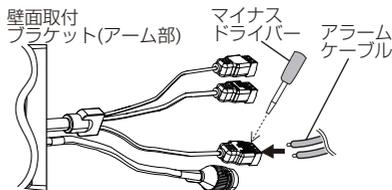
スクリューターミナルのピン端子にワイヤーを挿入してスクリューをマイナスドライバーで締めて固定します。スクリューターミナルはケーブルのコネクタ部から抜くことができます。ケーブルのコネクタ部から抜いて、配線したあとで差し込む場合は確実に奥まで差し込んでください。
