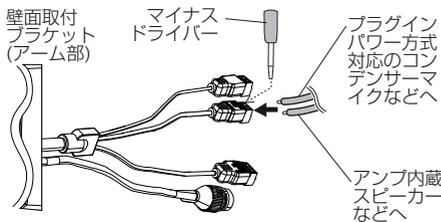
スクリューターミナルのピン端子にワイヤーを挿入してスクリューをマイナスドライバーで締めて固定します。スクリューターミナルはケーブルのコネクター部から抜くことができます。ケーブルのコネクター部から抜いて、配線したあとで差し込む場合は確実に奥まで差し込んでください。
