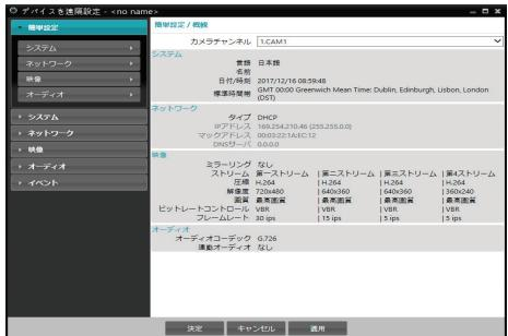
簡単設定では、エンコーダに接続されているカメラの使用時に要求されるシステム、ネットワーク、ビデオ、オーディオなどの機能に関する基本的な設定を行います。
