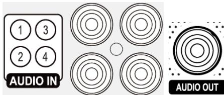
オーディオ機器を**AUDIO IN**（オーディオ入力）に接続し、アンプが内蔵されたスピーカーを**AUDIO OUT**（オーディオ出力）に接続してください。**AUDIO OUT**端子に接続すると、アナログカメラからの音声を聞くことができます。
