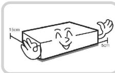
本機の後面には接続のための端子が突出しているため、壁に近すぎるところに設置するとケーブルが無理に曲がったり押さえつけられたりして破損する恐れがあります。壁から15cm以上の間隔を開けて設置してください。
