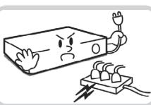
設置する前に必ず本機の電源をOFFにしてください。本機が使用するコンセントは、タコ足配線は止めてください。
