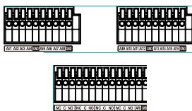
アラーム信号線を接続するには、ボタンを押したままボタンの下の穴に信号線を差し込みます。確実に接続しているか確認するため、ボタンを離して信号線を軽く引っ張ってみてください。信号線を外すには、上のボタンを押したまま信号線を引っ張ってください。
