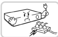
本機が作動するための電源電圧は、電圧の変動範囲が規程電圧の10%以内である必要があります。電源コンセントは必ず接地するようにしてください。電源ケーブルを接続するコンセントには、ヘアドライヤーやアイロン、冷蔵庫などの電熱器具と一緒に使用しないでください。
