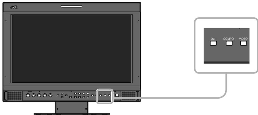
画面が消え、正面のINPUT SELECTランプ(DVI、COMPO.、VIDEO)が点滅したら...
