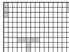
[△/▽/◀/▶]で選択エリアを選び、[実行]を押すとモニタ画面のエリア色が変わります。設定を解除するときは[キャンセル]を押します。
