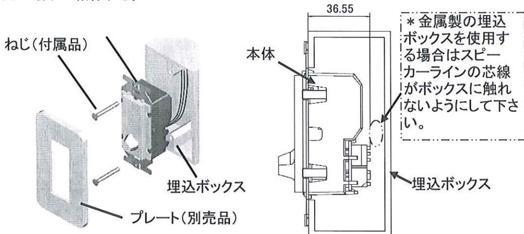
(2) 付属のねじ2本で埋込ボックスに取り付ける。
