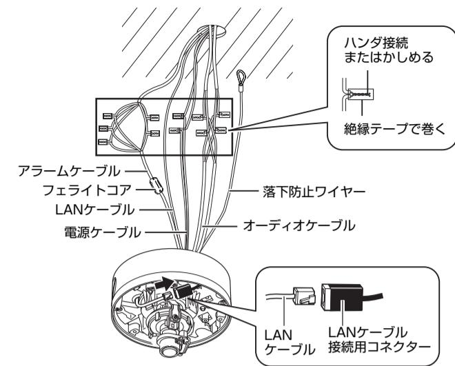
AC24 V電源ケーブル、アラーム入出力ケーブル、オーディオ入出力ケーブルは、それぞれのケーブルの端子同士をかしめる、またはハンダづけして接続します。
