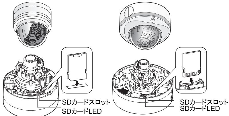
ドームカバーを外してからSDカードを挿入してください。
