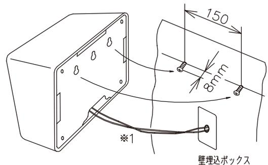
使用リード線:耐熱(105 $^{\circ}$ C)ビニールワイヤー(より線)、長さ:引出口より300 mm
