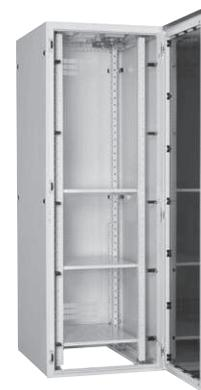
材質:鉄 ハンドル:ハンドル(キーNo.N200) 規格:EIA規格 塗装色:ペールホワイト(10YR8.5/0.5) 日塗工J19-85A 許容荷重:600kg 耐震荷重:300kg/兵庫県南部地震波(818gal)※代表機種(FS90-720EN)の日東工業(株)搭載条件による試験結果です 外形寸法・質量:幅600×高さ2000×奥行900mm,118kg 標準装備品:スリット付台板セット(RD152-60SN)×3セット、換気扇・低騒音タイプ×4コ(プラグコード付)、コンセントバー(RD81-10N)×1コ、ケーブルホルダー(RD87-1SK)×1セット(10コ入)
