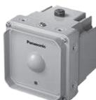
【無線部】周波数:57~64GHz 変調方式:MCS1~MCS12(BPSK/QPSK/16QAM)
