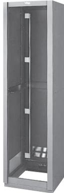
ユニット取付寸法:1826mm(EIA 41ユニット) ユニット取付最小間隔:44mm 寸法・質量:幅570×高さ2000×奥行572mm、60kg 仕上:ティープグレー半艶レーザー焼付塗装(マンセル1Y2/0.2近似)
