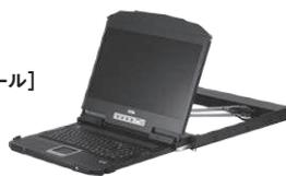
コンピューター接続数:ダイレクト:1、最大:接続するKVMスイッチに依存 画面サイズ:18.5インチ
