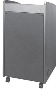
ユニット取付寸法:前面/EIA 17U、天面/EIA 7U 寸法・質量:幅556×高さ1043×奥行580mm、35.5kg 仕上:前面/黒色サランネット張り(マンセルN1近似)、側面/ダークグレー化粧シート貼り(マンセルN3.5近似)、その他/黒色焼付塗装(マンセルN1近似)
