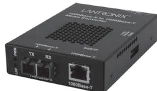
SGETF1013-110:1000BASE-T(RJ-45)[100m]⇔1000BASE-SX 850nmマルチモード(SC)[550m] SGETF1014-110:1000BASE-T(RJ-45)[100m]⇔1000BASE-LX 1310nmシングルモード(SC)[10km] 動作温度:0~50℃ 電源:ACアダプタ:DC12V(付属)
