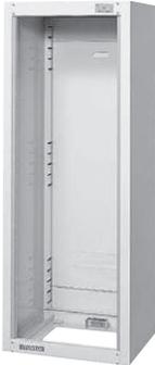
ユニット取付寸法:1379mm(EIA 31ユニット) ユニット取付最小間隔:44mm 寸法・質量:幅570×高さ1503×奥行454mm、約40kg 仕上:アイボリー半艶焼付塗装(マンセル2.5Y9/1近似)
