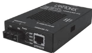
E-100BTX-FX-06(SC):100BASE-TX(RJ-45)[100m]⇔100BASE-FX 1300nmマルチモード(SC)[2km] E-100BTX-FX-06(SM):100BASE-TX(RJ-45)[100m]⇔100BASE-FX 1310nmシングルモード(SC)[20km] 動作温度:0~50℃ 電源:ACアダプタ:DC12V(付属)
