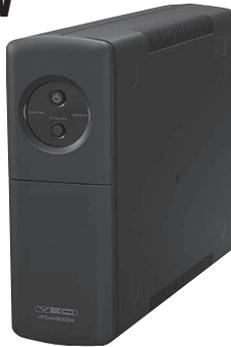
バッテリータイプ:小型シール鉛蓄電池(期待寿命4~5年) 運転方式:常時商用給電方式(正弦波出力) 入力電圧範囲:AC85V~115V 入力プラグ形状:NEMA5-15P(変換プラグ付) 出力コンセント:NEMA5-15Rロック式コンセント 最大出力容量:800VA/500W 外形寸法・質量:幅85×高さ240×奥行き330mm、7.0kg 付属品:取扱説明書、3P-2P変換プラグ、UPS電源管理ソフト、専用通信ケーブル(USB/RS232C) 保証期間:3年
