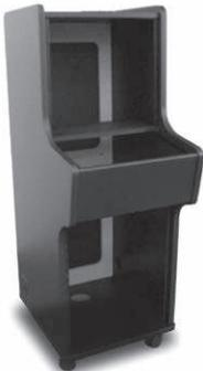
ユニット取付寸法:上部10U(奥行415mm)、下部14U(奥行531.5mm)、水平操作部6U(奥行185mm) ユニット取付最小間隔:44.5mm 使用キャスター:φ75mm×4(操作面側の2個はストッパー付) 寸法・質量:幅547×高さ1510×奥行745mm、45.7kg 仕上(主要部):ウレタンエナメル塗装(黒色)
