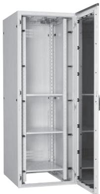
材質:鉄 ハンドル:ハンドル(キーNo.N200) 規格:EIA規格 塗装色:ペールホワイト(10YR8.5/0.5) 日塗工J19-85A 許容荷重:600kg 耐震荷重:300kg/兵庫県南部地震波(818gal)※代表機種(FS90-720EN)の日東工業(株)搭載条件による試験結果です 外形寸法・質量:幅600×高さ2000×奥行600mm,98kg 標準装備品:スリット付台板セット(RD152-30SN)×3セット、換気扇・低騒音タイプ×4コ(プラグコード付)、コンセントバー(RD81-10N)×1コ、ケーブルホルダー(RD87-1SK)×1セット(10コ入)
