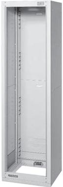
ユニット取付寸法:1826mm(EIA 41ユニット) ユニット取付最小間隔:44mm 寸法・質量:幅570×高さ2000×奥行454mm、約55kg 仕上:アイボリー半艶焼付塗装(マンセル2.5Y9/1近似)
