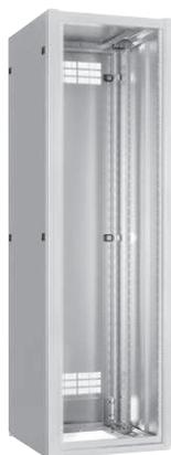
材質:鉄 規格:EIA規格 塗装色:ペールホワイト(10YR8.5/0.5)日塗工J19-85A 許容荷重:600kg 耐震荷重:300kg/兵庫県南部地震波(818gal)※代表機種(FSN80-620E)の日東工業(株)搭載条件による試験結果です 外形寸法・質量:幅600×高さ2000×奥行600mm,75kg
