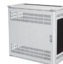
材質:鉄 ハンドル:平面ハンドル(キーNo.N200) 塗装色:ペールホワイト(10YR8.5/0.5)日塗工J19-85A 取付部:19インチマウントユニット(2.3mm)、木製基板(12mm)、キャビネット板厚ボデー0.8/1.6mm、右ドア0.8mm、左側板0.8mm、開口プレート1.0mm、天板/底板0.8mm 扉形式:前面および右側面ドア式
