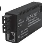
M/E-ISW-FX-02(SC):100BASE-TX(RJ-45)[100m]⇔100BASE-FX 1300nmマルチモード(SC)[2km] M/E-ISW-FX-02(SM):100BASE-TX(RJ-45)[100m]⇔100BASE-FX 1310nmシングルモード(SC)[20km] 動作温度:-40~75℃ 電源:別売(DC12V~48V)
