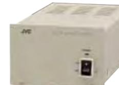
分配数: 1入力6分配、または2入力各3分配 映像入力: 2回路、VBS1.0V (p-p)、75Ω、BNC (スルーアウトプット、75Ω終端スイッチ付) 映像出力: 3回路×2、VBS1.0V (p-p)、75Ω、BNC ケーブル補償: 2ポジション切換式 (「切」/補償なし、「入」/5C-2V 150mを補償) 電源: AC100V、50Hz/60Hz 消費電力: 4.9W 周囲温度: -10°C~+50°C (動作)、0°C~+40°C (推奨) 外形寸法・質量: 幅140×高さ93×奥行239mm、1.6kg 仕上: マンセル3Y6/0.6近似 (ライトグレー) 適合ラックマウント金具: UC-P1012 (EIA 2U) (別売) 付属品: ラックマウント金具 (EIA 1U)、スクリーン×4
