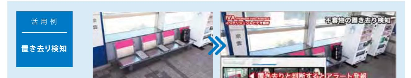
不特定多数の人が利用するターミナル、ビル、商業施設などに対応。映像内のオブジェクト(物体)の差分情報を時間軸で検知し、設定時間を超えた滞留(放置)を異常と判断。リアルタイムのアラート発報により、職員や警備スタッフの迅速な指示、対応を実現します。
