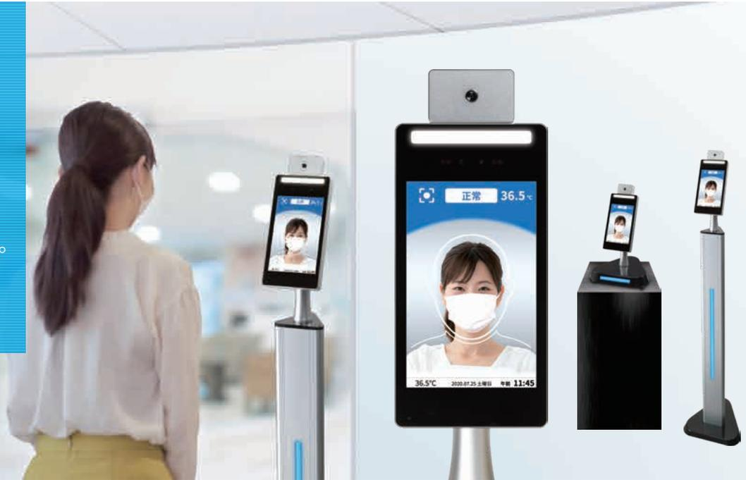
「AI検温ステーション VA110」は、赤外線センサーとカメラの顔認識AIによる検温で体表面温度を測定し、結果を音声と画面でお知らせします。
