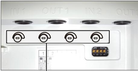
外部音声入出力音量調整つまみ
