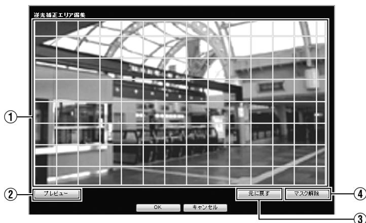
測光エリアを被写体に合わせて設定します。設定は編集ウィンドウに表示されているブロック単位になります。設定が終わったら [OK] ボタンを押してください。編集ウィンドウが閉じます。そのあと、[カメラ] ページの [OK] ボタンを押してください。設定が保存されます。
