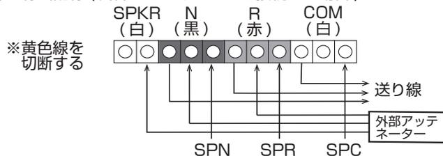
\*切断した黄色線は、必ず絶縁処理を行なってください。
