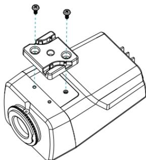
カメラ下部または上部にブラケットを設置してカメラを固定することができます。ブラケット設置時1/4-20 UNC (20スレッド)、2.5mm +/- 0.2mm (ISO標準)または0.197 (ASA標準)の標準ネジを使用してください。
