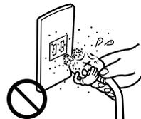
この機器の電源コンセント(ACアウトレット)に、ヒーター、ドライヤーや電磁調理器などの消費電力の大きい機器をつながない
