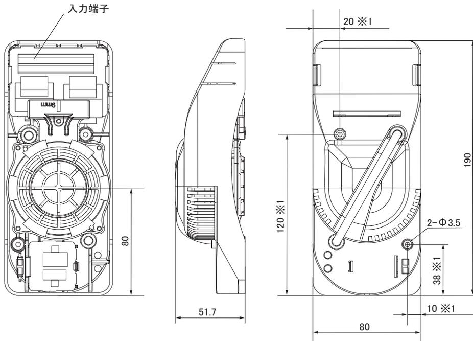
※1:システム天井取り付け用穴寸法
